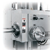
Avanço manual do eixo W com 2 velocidades. (5 mm/volta e 20 mm/volta)
