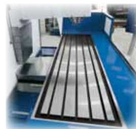
Ampla mesa com proteções telescópicas nos eixos X, Y e Z
