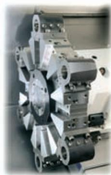
Torre servo-hidráulica com 12 posições
