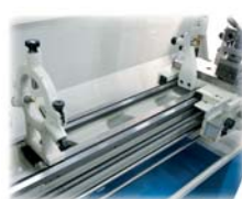
Estrutura do barramento reforçada
