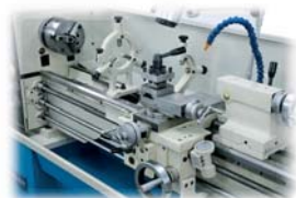
Carro transversal, refrigeração e iluminação
