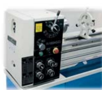
Painel de comando
