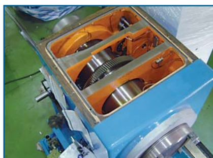
Duas (2) gamas de velocidades com trocas rápidas para usinagens pesadas
