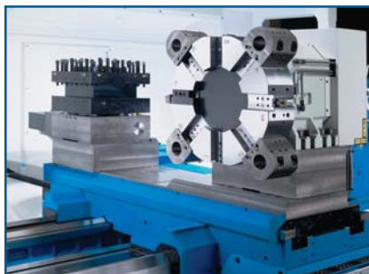
Torres combinadas com 8 (Hidráulica) e 4 (Elétrica) posições para todos os processos
