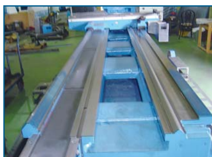
Estrutura do barramento fundida em uma única peça
