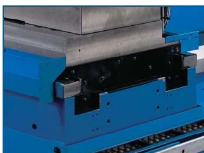
Estrutura do barramento fundida em uma única peça
