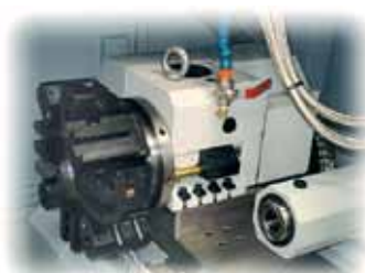
Conjunto torre e contra-ponta
